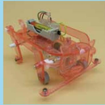
ニッパー・ドライバーなどで豚型ロボットを組立ながらモーターと機構について学びます
