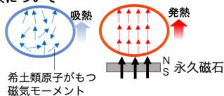
希土類化合物に永久磁石や超電導マグネットを用いて外部磁場を加える(取り除く)と、希土類元素がもつ磁気モーメントが秩序化(乱雑化)する。この際に生じる発熱(吸熱)を利用して冷却を行う。
