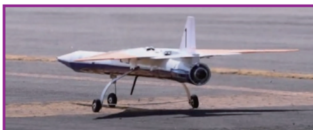
第二世代オオワシ1/3サブスケール機の後ろ姿(ジェットエンジン搭載)
