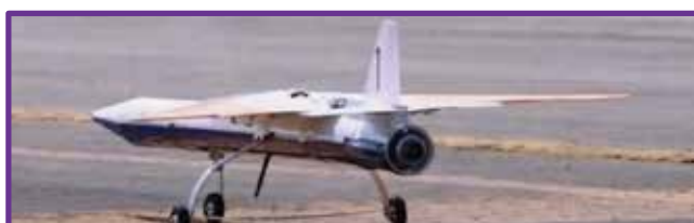
第二世代オオワシ1/3サブスケール機の後姿（ジェットエンジン搭載）
