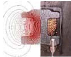
電子部品の磁界解析例
