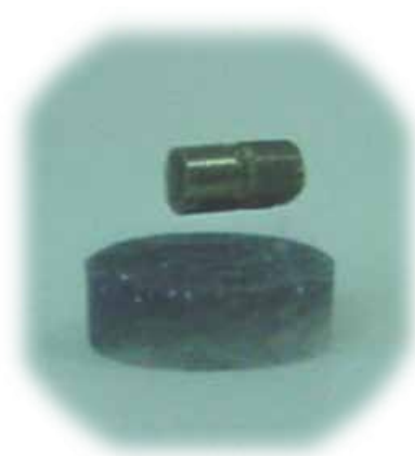
図2 高温超伝導体の上に磁石が浮いている様子
