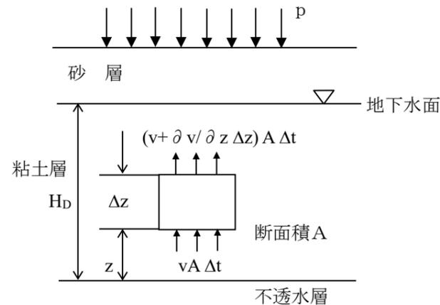
図-1 一次元圧密における透水と作用応力
