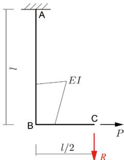
上図のように、C 点の下向きに仮想荷重  $R$  を載荷させる。
