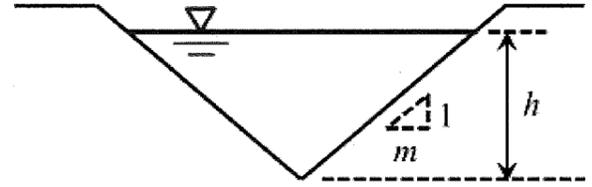
(2) 図に示す二等辺三角形断面水路で, 比エネルギー  $E$  (m) が最小となる水深が限界水深  $h_c$  (m) である.  $h_c$  を  $Q, m$  および  $g$  で表わせ. また, その際の比エネルギー  $E_c$  (m) と  $h_c$  (m) の関係を数式で示せ.
