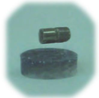
図2 高温超伝導体の上に磁石が浮いている様子
