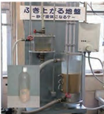
写真1 液状化実験と「エッキー」
