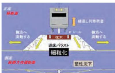
線路に敷設しているパラストの沈下メカニズム
