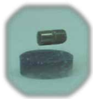
図2 高温超伝導体の上に磁石が浮いている様子
