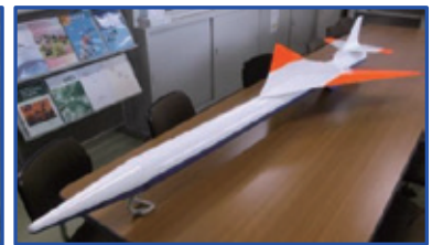
第二世代オオワシの1/3サブスケール機
