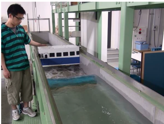
写真1 津波による列車転倒の再現実験
