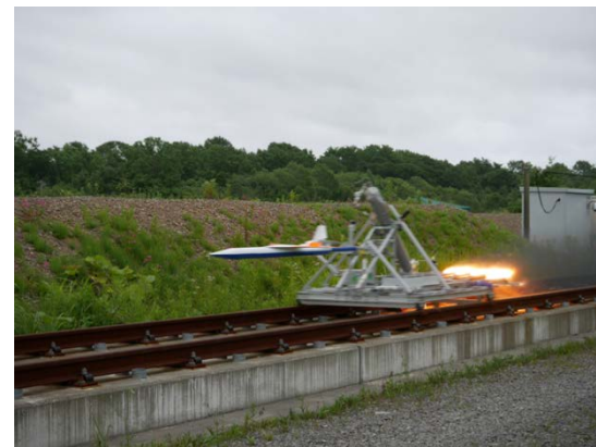
高速走行軌道実験設備を用いた 小型無人機の空力特性試験
