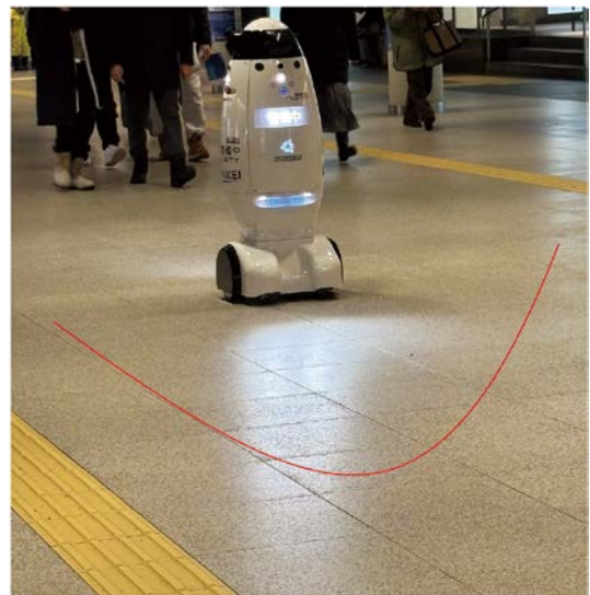
床面照明によるロボット中心のバブル効果
