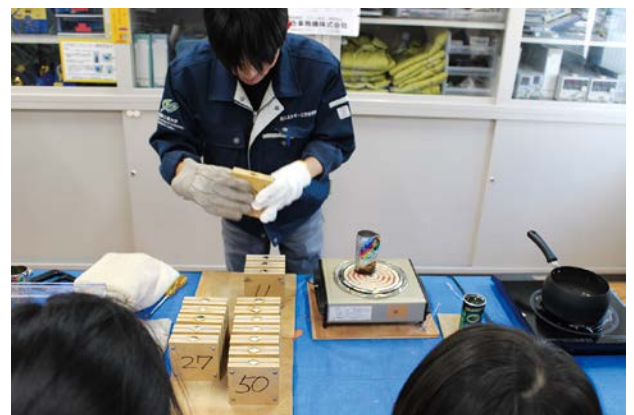
鑄型に溶かしたスズを流し込む様子
