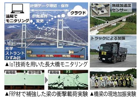
▲IoT技術を用いた長大橋モニタリング ▲FRP材で補強した梁の衝撃載荷実験 ▲橋梁の現地加振実験
