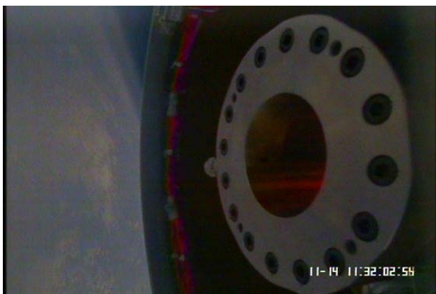
宇宙空間で動作したデトネーションエンジン (令和6年11月14日実施) (名古屋大学/JAXA 提供)
