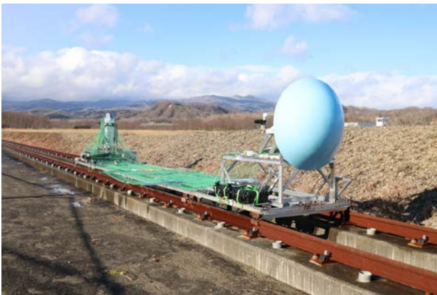
ロケットスレッド試験台車全景 (水色の物体は大気への再突入カプセル)
