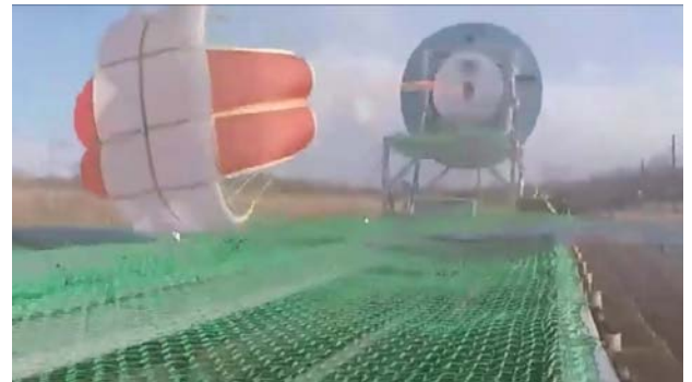
カプセル後方でのシュート開傘の様子 (機上カメラにて撮影)
