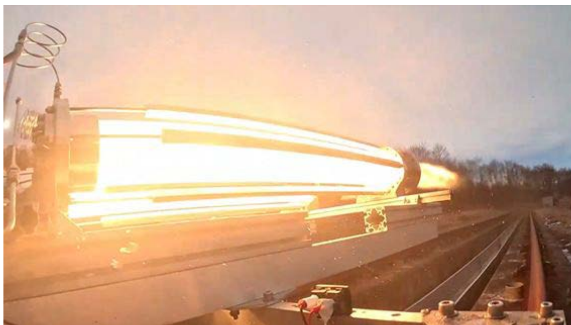
燃焼中の5kN級ハイブリッドロケット（2本クラスタ運用） （12ページに関連記事あり）
