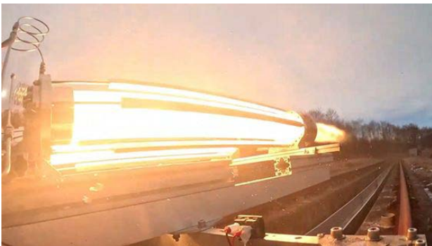
燃焼中の5kN級ハイブリッドロケット（2本クラスタ運用）
