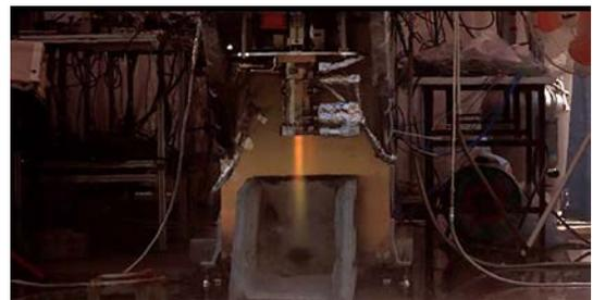
BBM縦置き燃焼試験 (5/25実施、Run106、3秒燃焼)
