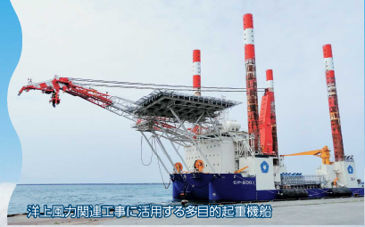
洋上風力関連工事に活用する多目的起重機船
