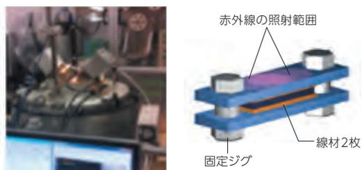
図2 超伝導線材接合用赤外線導入加熱装置の外観(左)と線材の接合イメージ(右)
