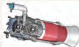
図2 GG-ATRエンジンの概観
