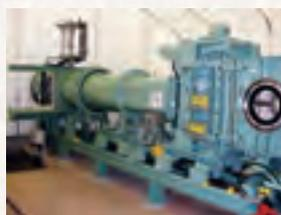
図1 中型超音速風洞
