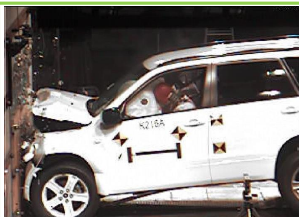
図1 車両のフルラップ前面衝突実験
